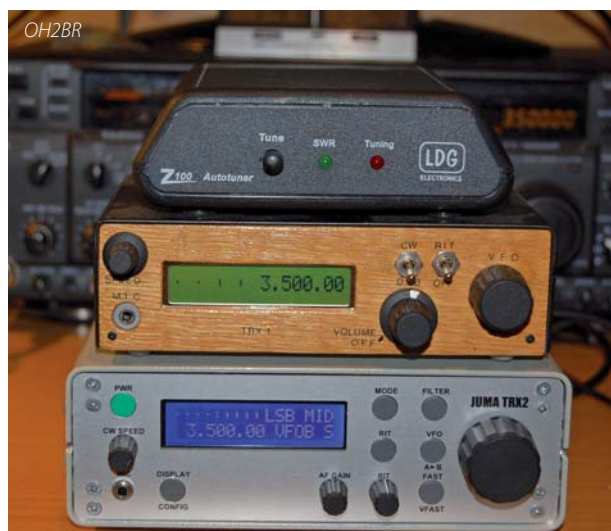
Automaattinen antennivirityslaite LG Z-100, sen alla Juma-radio TRX1 ja alinna Juma-radio TRX2A.
